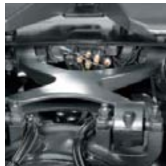
Х-образный рычаг на задней оси выполняет функцию стабилизатора и треугольного рычага подвески
