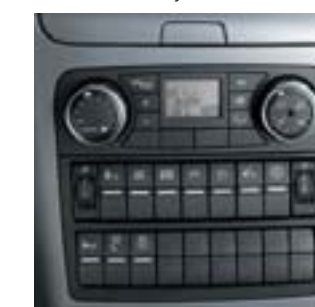
Новые элементы управления климатической установкой
