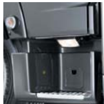
Фонарь в ступеньке входа в кабину.
